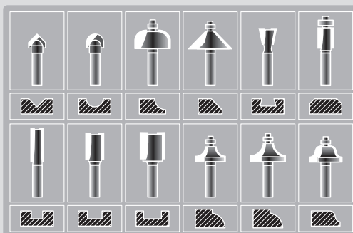
Abb. 1, Profilform an Abhängigkeit vom eingesetzten Profilfräser
