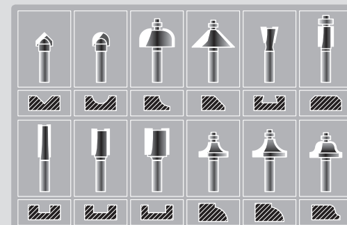
Obr. 1, tvar profilov v závislosti od použitej tvarovej frézy
