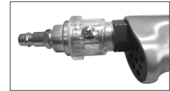
4. A levegőolajozót csatlakoztassa a kompresszor levegőtömlőjéhez.
