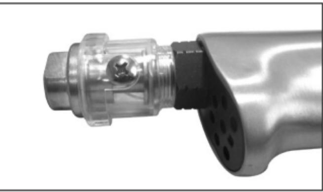
3. A gyorscsatlakozó-toldatot (nem része a csomagolásnak) csavarozza fel a levegőolajozó menetére.
