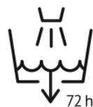
Každý tretí deň vyprázdnite a znova naplňte nádržku. Pred naplnením ju vyčistite vodou z vodovodu alebo čistiacimi prostriedkami, ak ich požaduje výrobca. Odstráňte prípadný vodný kameň, usadeniny alebo povlak, ktorý sa vytvoril na stenách nádržky alebo na vnútorných povrchoch a všetky povrhy do sucha utrite.
