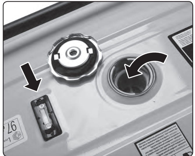
Obr. 13, ukazovateľ množstva paliva v nádrži a sítka v hrdle palivovej nádrže
