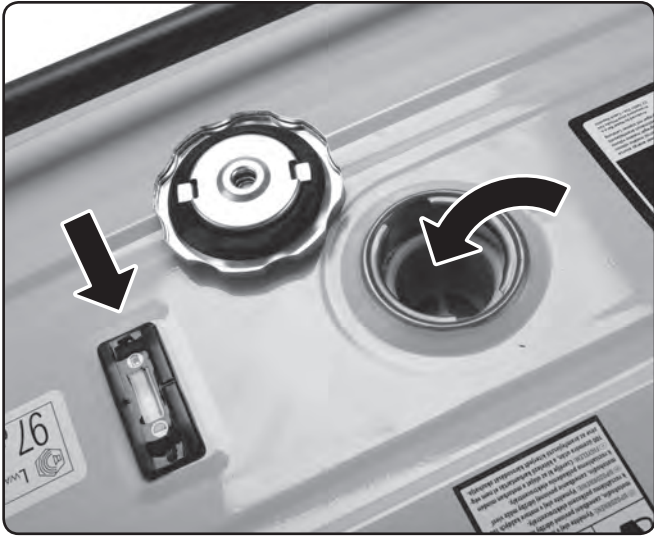
Abb. 13, Treibstoffmengenanzeige im Tank und Sieb in der Kraftstofftanköffnung
