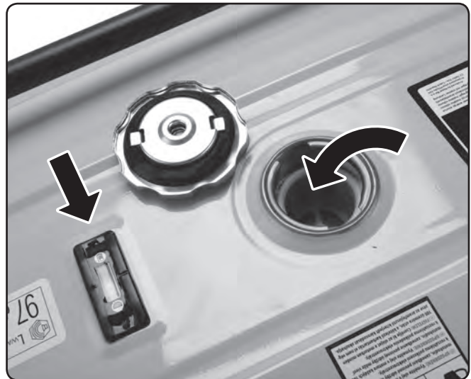
13. ábra. A tartályban lévő üzemanyag mennyiségét mutató kijelző és az üzemanyag szűrőszítája
