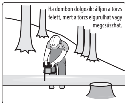
19. ábra. A fatörzs keresztbe vágása / rövidítése
