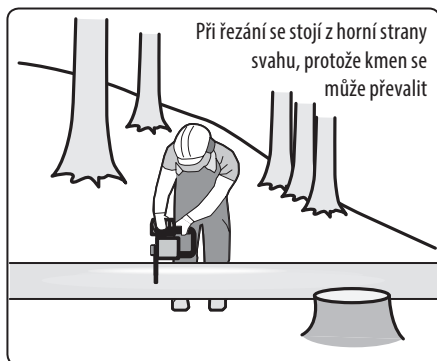
Příčné řezání / krácení kmene, obr. 19
