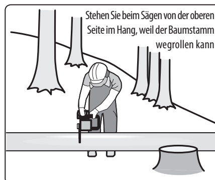
Querschneiden/-ablängen von Stämmen, Abb. 19
