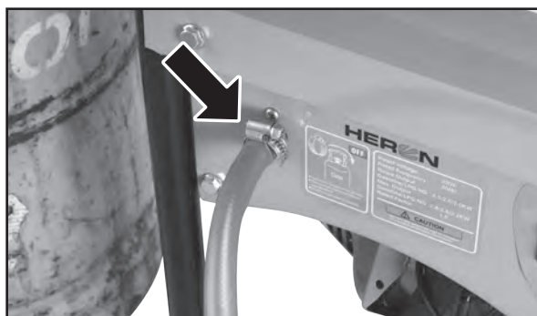
Způsob připojení plynové hadice k elektrocentrále Obr. 14
