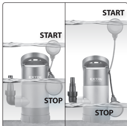
Obr.4, ilustrace funkce plovákového spínače
