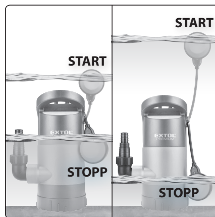
Abb. 4, Darstellung der Schwimmerschalterfunktion
