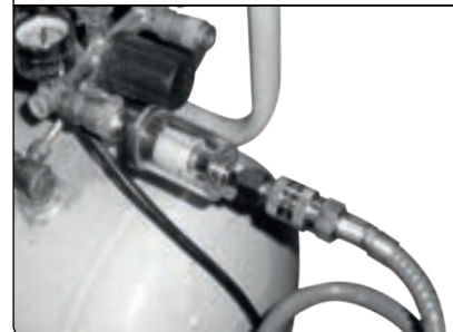
Obr. 10, připojení filtru (odlučovače) Extol® Craft 8865101
