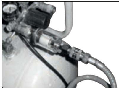
10. ábra. Extol® Craft 8865101 szűrő (leválasztó) bekötése
