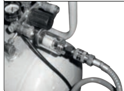
Obr. 10, pripojenie filtra (odlúčovača) Extol® Craft 8865101
