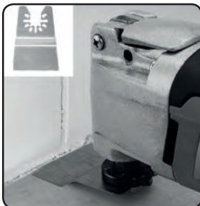
Obr.2, odstraňování zbytků lepidla či tmelů škrabkou
