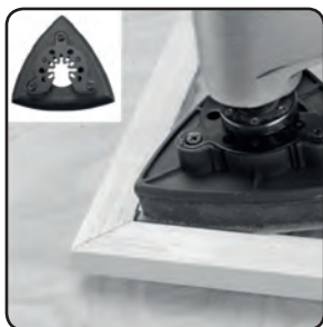
Obr.1, obrúsenie v rohoch brúsou delta doskou
