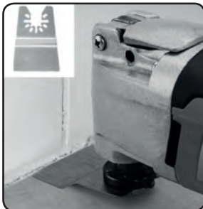
Obr.2, odstraňovanie zvyškov lepidla či tmelu škrabkou
