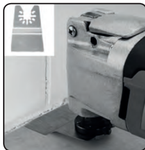
2. ábra. Ragasztó- és tömítőanyag maradványok eltávolítása kaparóval.
