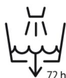
Každý třetí den vyprázdněte a znovunaplňte nádržku. Před naplněním ji vyčistěte vodou z vodovodu nebo čistícími prostředky, pokud je požaduje výrobce. Odstraňte případný vodní kámen, usazeniny nebo povlak, který se vytvořil na stěnách nádržky nebo na vnitřních površích a všechny povrchy do sucha otřete.
