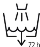
Vacíe y vuelva a llenar el depósito de agua cada tres días. Antes de llenarlo, límpielo con agua del grifo o producto de limpieza, si lo solicita el fabricante. Elimine los restos de cal, suciedad o películas que puedan acumularse en las paredes del depósito o en las superficies interiores y seque todas las superficies con un paño.
