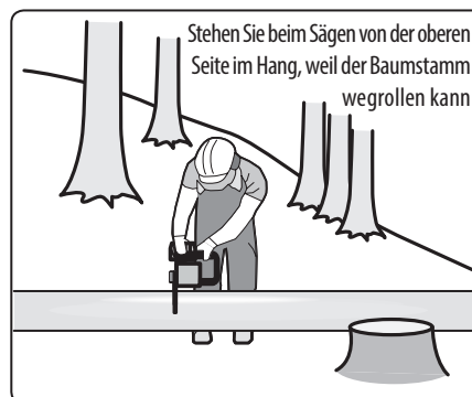
Querschneiden/-ablängen von Stämmen, Abb. 19
