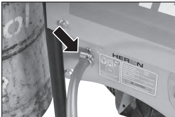
Spôsob pripojenia plynovej hadice k elektrocentrále Obr. 14
