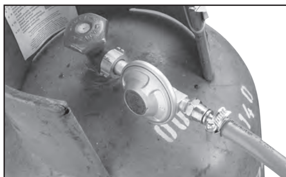
Připojení plynové hadice k propan-butanové lahvi přes redukční ventil Obr. 15
